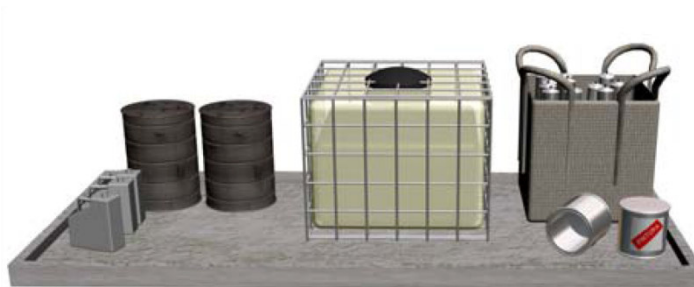
Cubeto impermeabilizado para almacenamiento de residuos peligrosos
